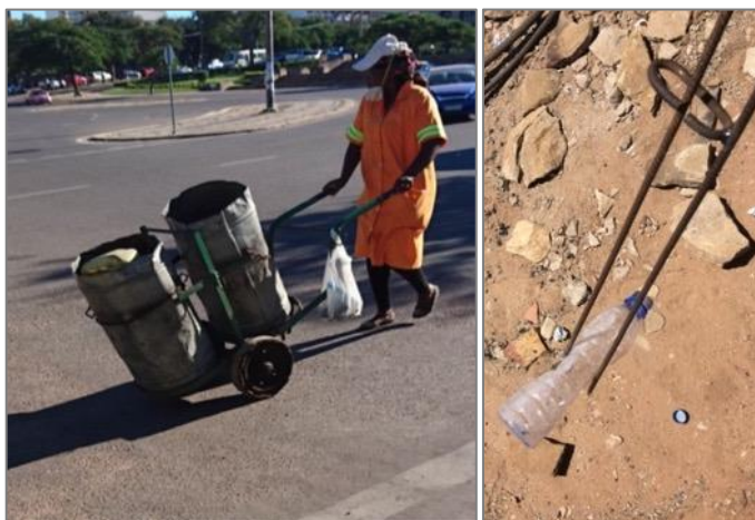
Figura 33 – Carrinha de mão com tambores (esq.) e pinça para limpeza urbana (dir.)
